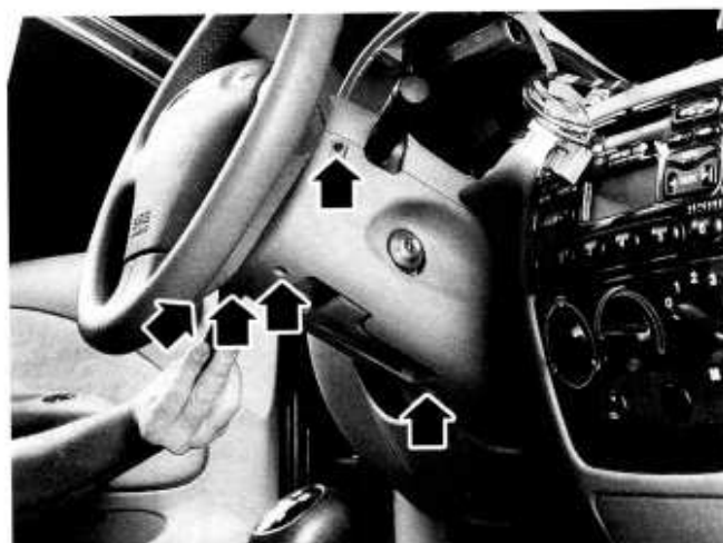
Rys. 10.22. Śruby mocowania połówek osłony wału kierownicy
