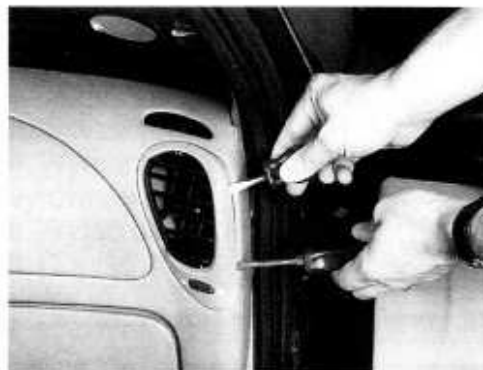
Rys. 10.26. Wymywanie prawego boczego nawietrznika
