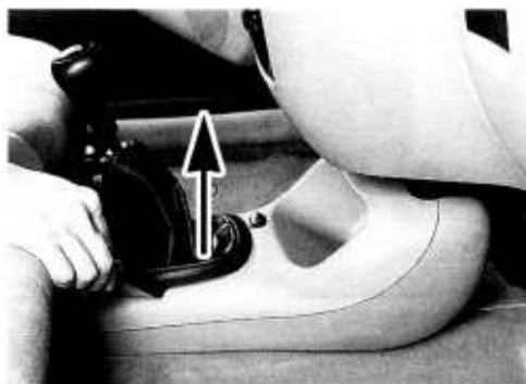
Rys. 10.33. Zdejmowanie osłony dźwigni zmiany biegów
