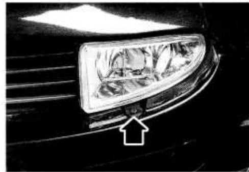
Rys. 10.15. Śruba mocowania reflektora przeciwmgłowego
